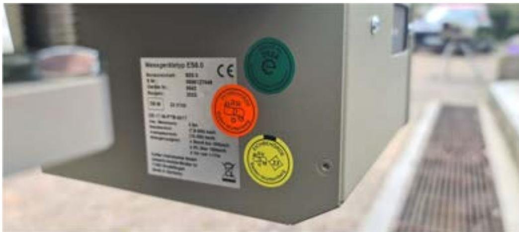
Abbildung 50: Eichsiegel an einer ESO ES 8.0 Anlage<sup>81</sup>
