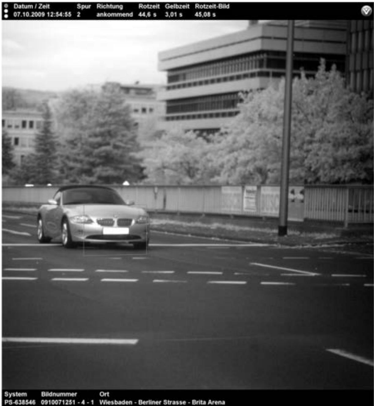
**Abbildung 19: Verwertbare Aufnahme Rotlichtsystem**
