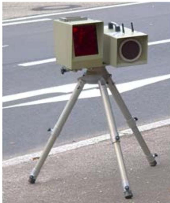
Abbildung 52: ESO 8.0 Kamera mit Blitzmodul<sup>94</sup>
