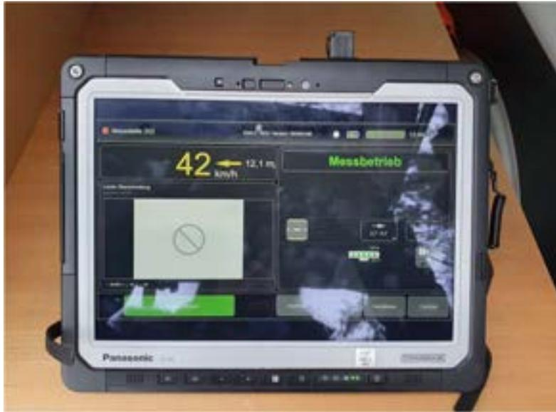
Abbildung 53: ESO 8.0 Bedienelement<sup>95</sup>
