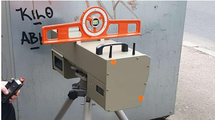
Abbildung 40: ESO ES 8.0 - Ausrichten<sup>114</sup>
