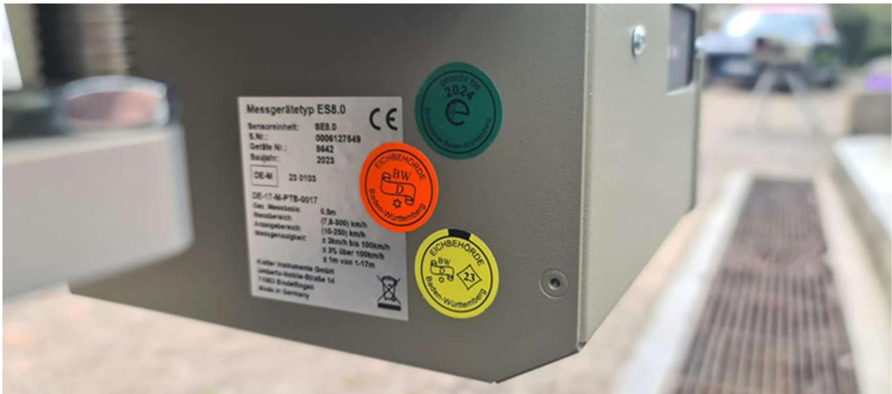
Abbildung 50: Eichsiegel an einer ESO ES 8.0 Anlage<sup>124</sup>
