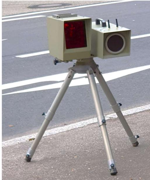
Abbildung 52: ESO ES 8.0 Kamera mit Blitzmodul<sup>137</sup>
