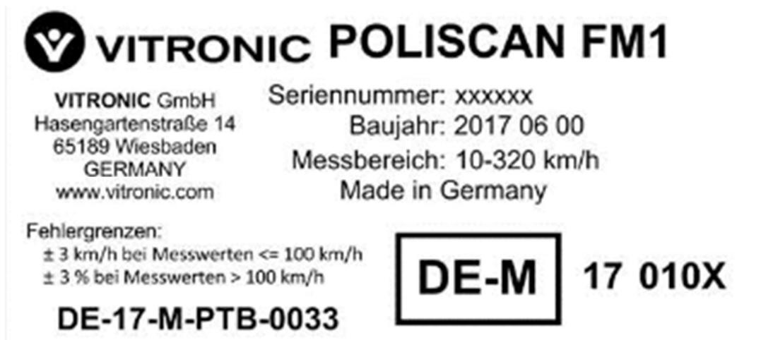
Abbildung 10: Typenschild<sup>81</sup>
