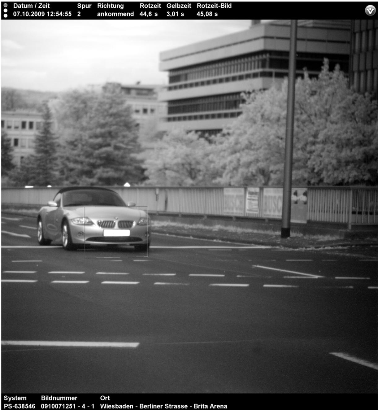
**Abbildung 19: Verwertbare Aufnahme Rotlichtsystem<sup>90</sup>**
