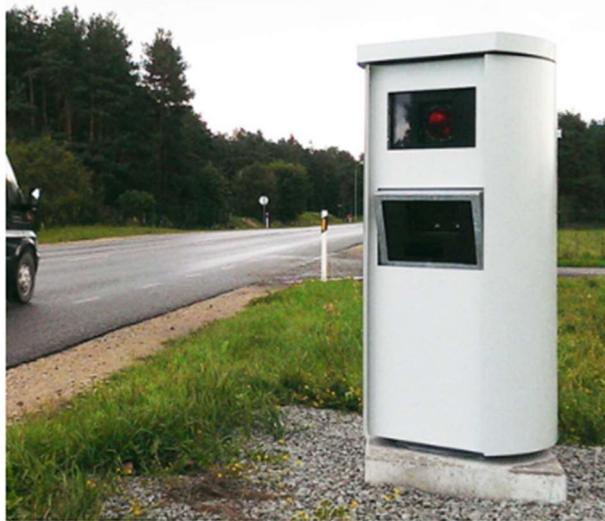
Abbildung 7: Betrieb im Außengehäuse Messkabine<sup>78</sup>
